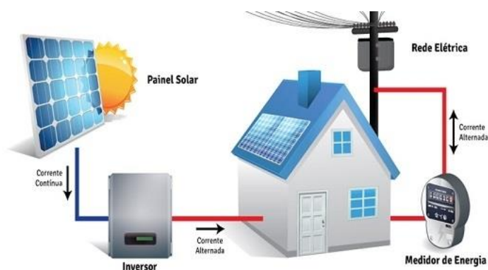
Figura 3: Sistema fotovoltaico conectado à rede.
